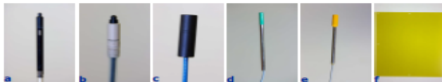
Figure 1 : a) Exradin A16 Standard Imaging b) CC04 IBA c) MicroLion 31018 PTW d) SFD IBA e) PFD IBA f) EBT3 ISP
